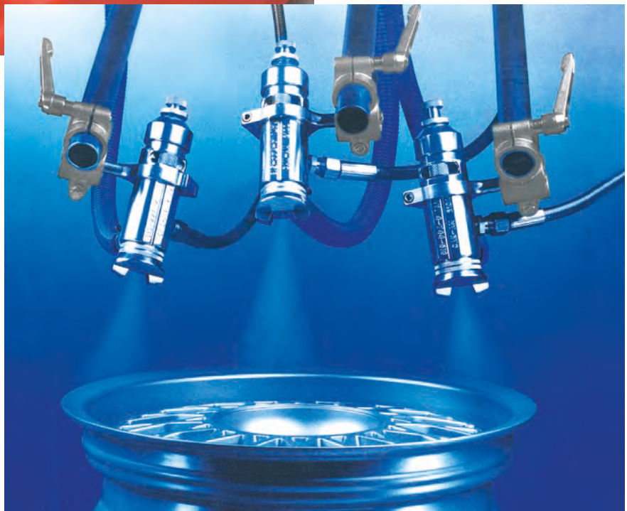
Airbrush - Halterung mittels Kreuzklemmstücken und Klemmhebeln.
