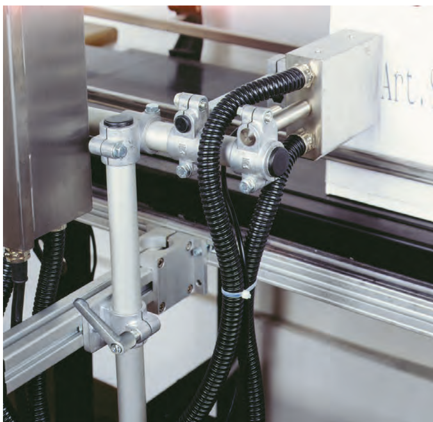
Druckkopfhalter an einer Verpackungsmaschine - Universell verschiebbar.
