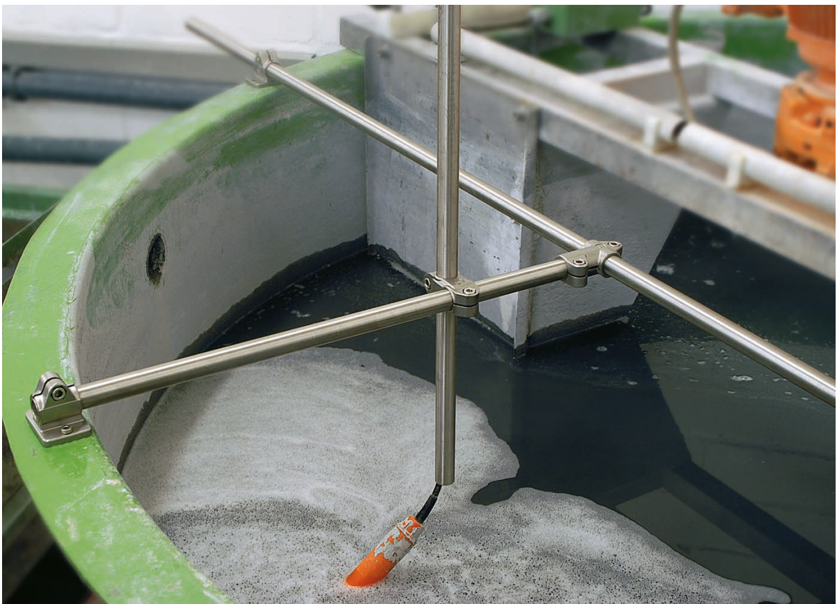
Einfache Sondenhalterung in aggressiver Umgebung.
