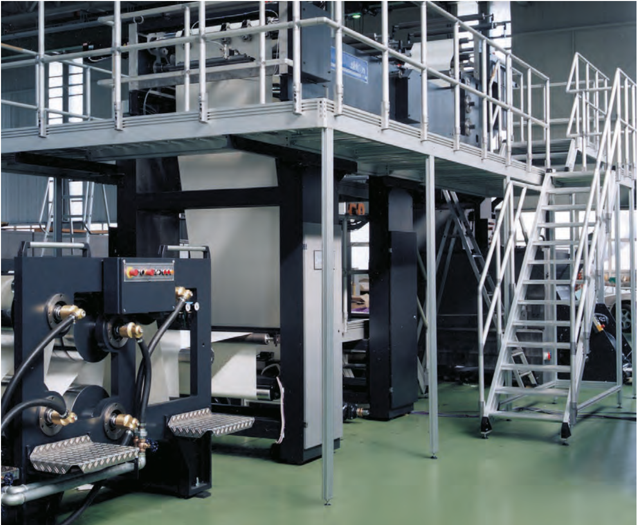
Arbeitsbühne mit Aufgang an einer Rollenoffset-Maschine.
