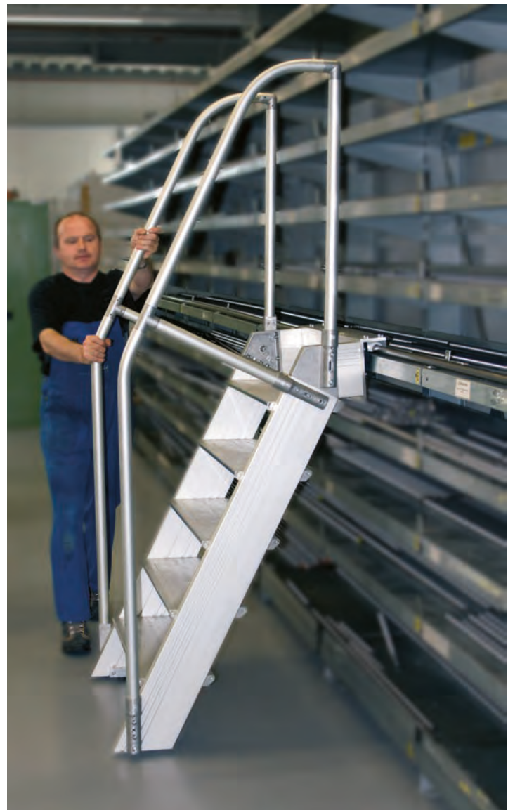
Verfahrbare ITAS-Leiter vereinfacht den Zugriff auf verschiedene Lagerfächer.
