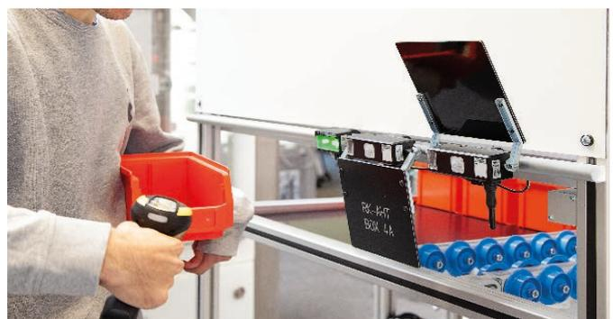
Über einen Scanner wird ein QR-Code an einer Kiste eingelesen und das System öffnet das richtige Fach zur Nachbefüllung.
