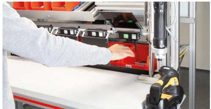
Der Mitarbeiter wird Schritt für Schritt durch Öffnen der Klappen und Aufleuchten einer Anzeige zum korrekten Bauteilbehälter geleitet.
