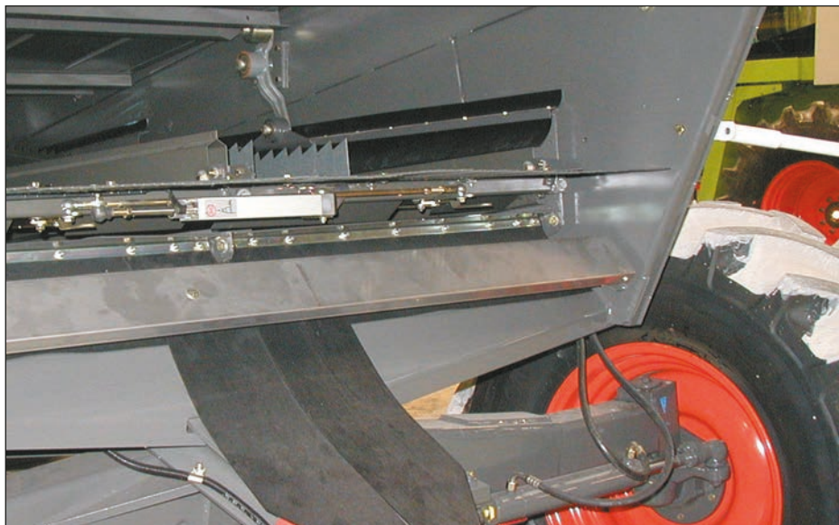
Mähdrescher-Siebverstellung durch Elektrozyylinder Baureihe 010. Einsatz unter extremen Bedingungen (Hitze, Staub und Erschütterungen).
